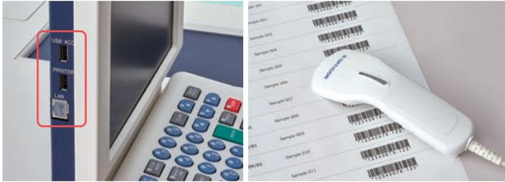
USBポートから外部入力デバイス\*2 (バーコードリーダー・キーボード)の接続が可能です。バーコードリーダーにより試料名の登録が省力化されます。USBメモリ\*2によるデータ保存にも対応しています。
