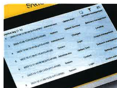
デバイスログ機能は、すべての設定変更を記録し、タイムスタンプを含むトレーサブルなログファイルを作成します
