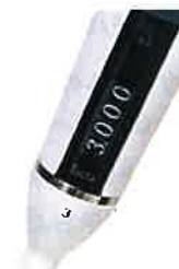
(図c) 例：最大容量3 µLのピペット 0.002 µLずつ容量を表示します。
