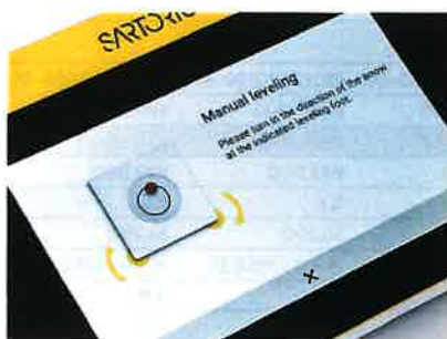
オートレベルリングと自動校正調整機能により、エラーのないひょう量を実現
